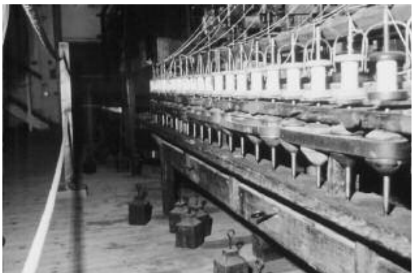
Mit der Water Frame gelang es erstmals, Baumwolle mit einer Maschine kontinuierlich zu spinnen
