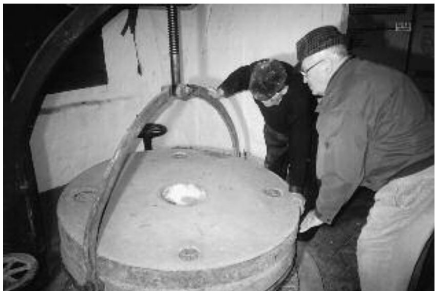
Mit Hilfe der Mechanik heben Heinz Fleermann und Müller Franz Krause den oberen Mühlstein an und schwenken ihn zur Seite
