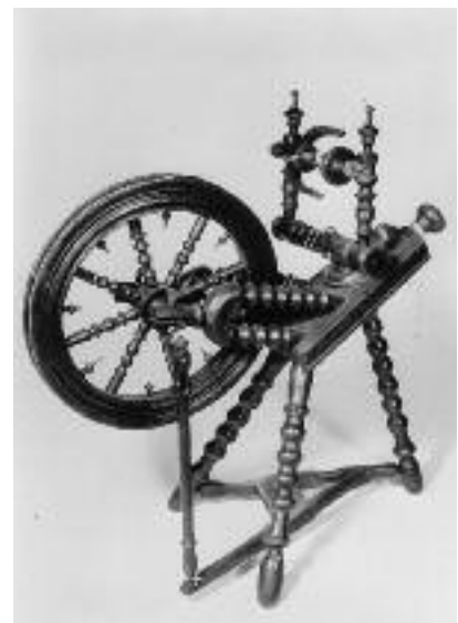
Mit dem fußgetriebenen Flügelspinnrad stieg die Produktivität, obwohl die Spinnerin bequemer, nämlich sitzend arbeitete
