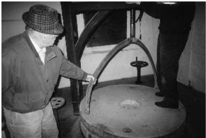
Unsere Bilder zeigen, wie früher ein Mühlstein von Zeit zu Zeit geschärft werden mußte. Der obere Mühlstein wird am Galgenbaum befestigt.
