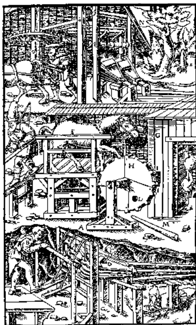
Antriebsvorrichtungen im mittelalterlichen Bergwerk: Göpel (oben), Tretrad (Mitte) und Fußbetrieb (unten)
