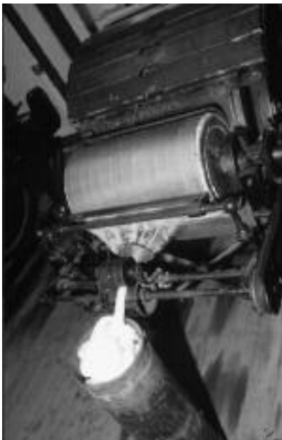
Die Spinnlunte fällt aus der Feinkarde in eine Kanne aus Blech
