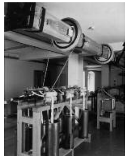
Das Streck- und Doublierwerk (im Vordergrund) und eine sogenannte Laternenbank (Mitte) im Ratinger Museum
