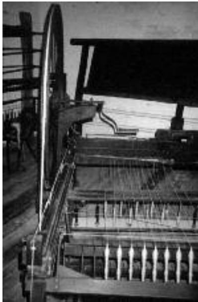
Teilsicht einer Spinning Jenny. Das Antriebsrad und die Spindeln sind gut zu erkennen
